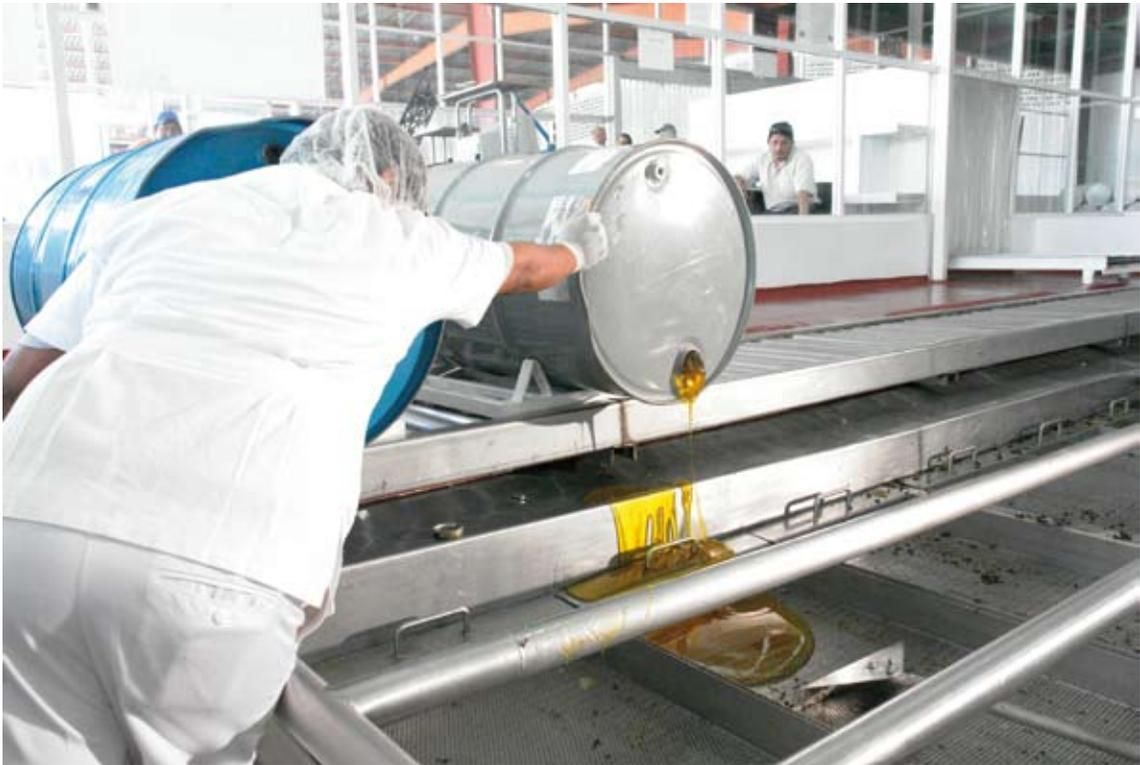
Este colador debe ser colocado entre la salida del extractor y la entrada al depósito de miel o tina de sedimentación, recomendándose que este sea de acero inoxidable grado alimenticio, con una malla cuya abertura máxima debe ser de 3 x 3 mm por cuadro.
